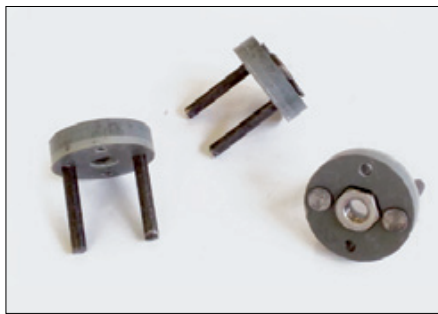
Fig. 2 I particolari dotati di bullone M8 con inserite le spine.
