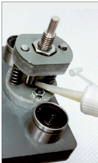
Fig. 4 - A lato, il sistema di recupero del gioco montato sulla testa portautensile e lubrificato con olio prima dell'installazione; sopra, esemplificazione del gioco.
